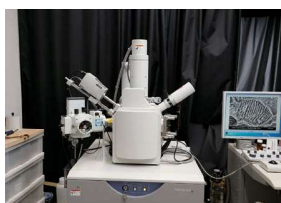
走査電子顕微鏡 (SEM) システム
